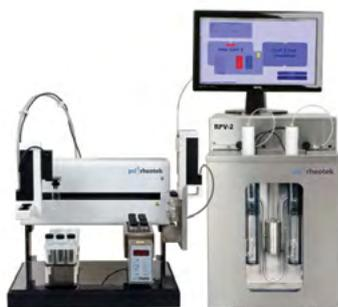
Компактный анализатор со встроенной подсветкой, системами нагрева/охлаждения, очистки и PC системой управления. Внешние модули: PC-монитор и клавиатура, бутылки для остатков пробы и промывочных растворителей. Количество измерительных ячеек от 1 до 4 (при двойной бане).
