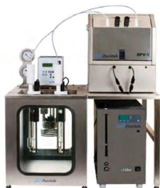
Модульная система позволяет автоматизировать каждую стадию проведения измерения кинематической вязкости раствора полимера. Количество измерительных ячеек от 1 до 4 (при двойной бане).
